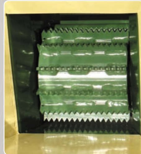
Rullo trascinatore idraulico Hydraulic feeding roller Rouleau ameneur hydraulique Hydraulische Mitnehmerwalze Rulo transportador hidráulico Hydraulische aanvoerrul
