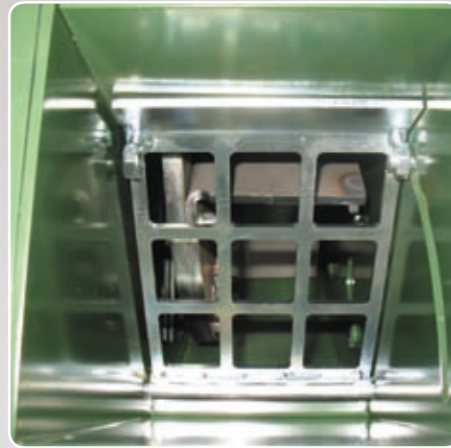
Vaglio di raffinazione regolabile Adjustable refining sieve Crible de raffinage réglable Einstellbares Sieb zur Verfeinerung Tamiz de refinamiento regulable Instelbaar rooster om de fijnheid te regelen
