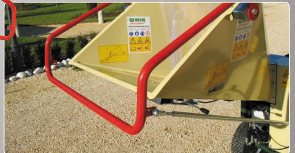
Maniglione di comando versione RI Control grip for RI version Poignée de commande pour la version RI Steuerungshandgriff für die Version RI Manillar de comando versión RI Bedieningshandgreep voor versie RI
