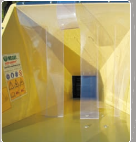
Ampia tramoggia di carico Wide loading hopper Grande trémie d'introduction Breiter Einführungstrichter Amplia tolva di carico Brede invoertrechter
